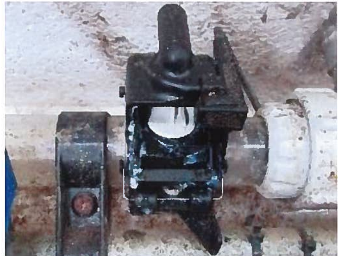
Abb. 12: Milchhahn mit Ablagerung von Milchresten
