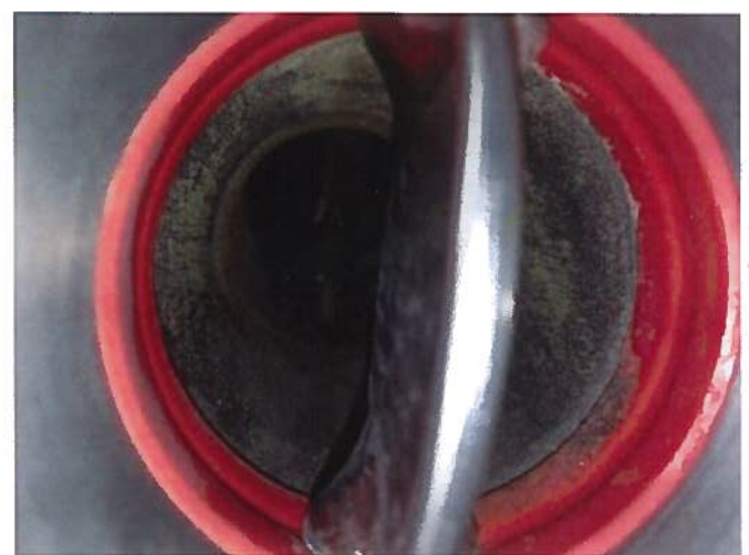
Abb. 9: Ablagerungen beim Klappenventil eines Milchtanks
