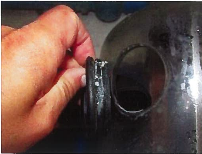
Abb. 4: Gummi-Stopfen der Endeinheit mit Ablagerungen
