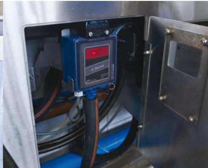
DeLaval MM25 - hohe Genauigkeit durch elektronisches Infrarot Messprinzip
