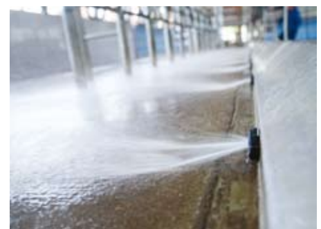
Deck Flush Sprühdüsen zur Reinigung des Arbeitsbereiches
